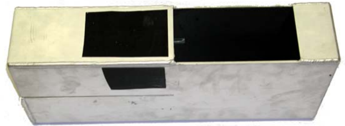
Figure 4.6 : boîte expérimentale pour mesurer la ténacité en mode II
