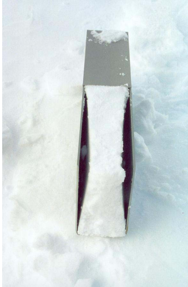
Figure 4.8 : déformation de la première boîte expérimentale (en plastique sans étais) après que celle-ci ait été enfoncée dans le manteau neigeux (voir les dimensions de la boîte sur la Figure 4.3 ).
